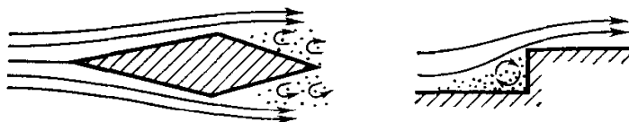
Ф и г. 2. Отрыв потока от поверхности, имеющей изломы.
